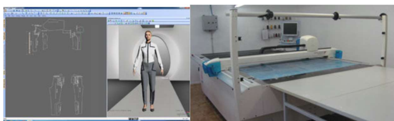
Software de proiectare a tiparelor Optitex și mașina automată de croit
