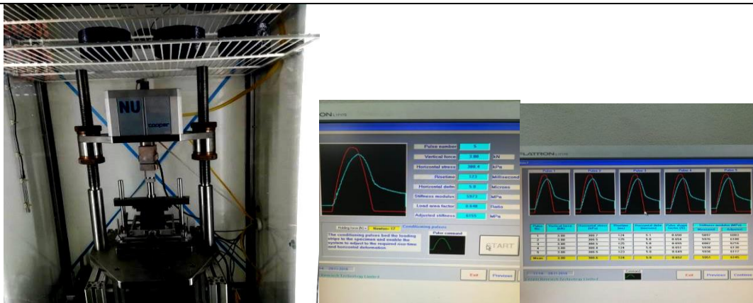
Fig. 10 - Determinare a modulului de rigiditate pe probe cilindrice, IT-CY
