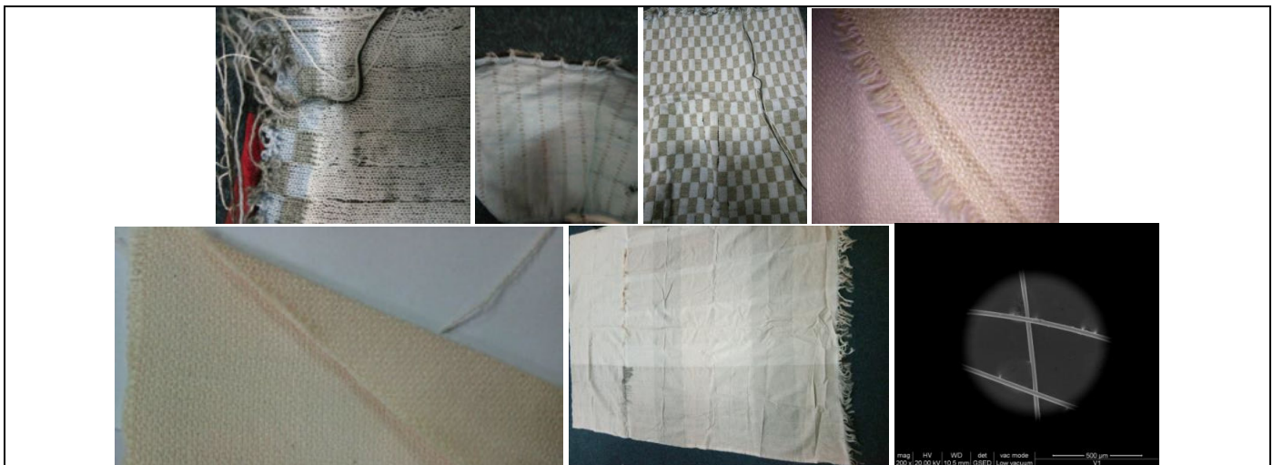
Fig. 20 - Variante structuri textile echivalente - selectie – faza laborator; detaliu SEM fire din fibre celulozice si HDPE – functionalizare high-tech
